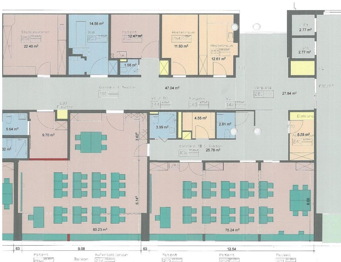
Abbildung 11: Mögliche Umnutzung von Betten- und Stationszimmern in Klassenzimmer durch Entfernung von Trennwänden. Aus zwei, resp. 3 Bettenzimmern wird je ein Klassenzimmer.
