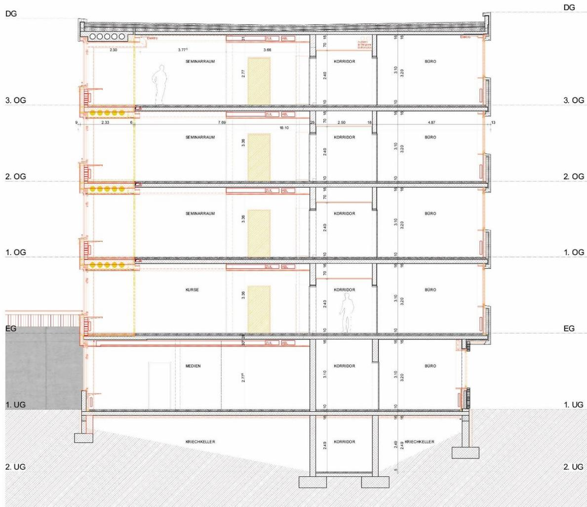
Abbildung 13: Der Querschnitt durch den sanierten Bettentrakt zeigt auf, dass die Gebäudehülle vollständig energetisch ertüchtigt wird. Durch den Ersatz der Fenster sowie die Nachdämmung im Brüstungsbereich und an der Kellerdecke wird der MINERGIE-Standard erreicht.
